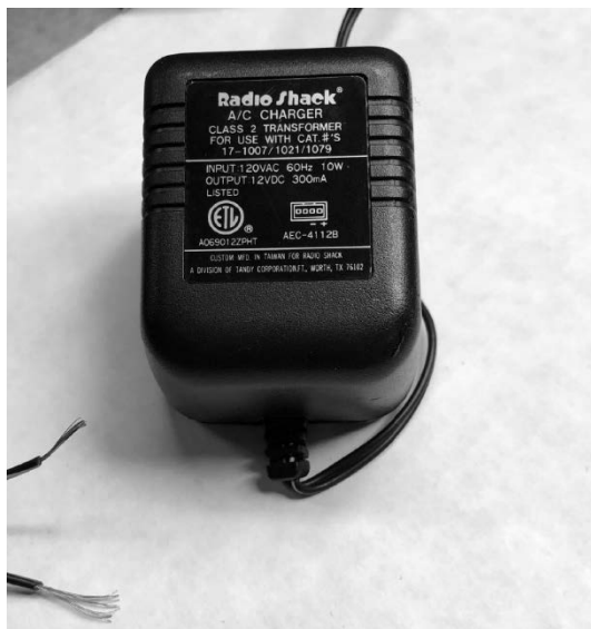
Rysunek 5.2. Zasilacz transformatorowy AC/DC
